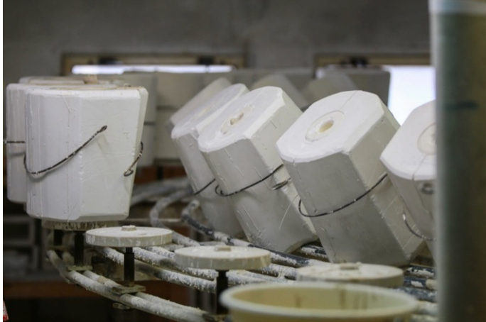
LÍTÍ PORCELÁNU DO OTEVŘENÉ FORMY
