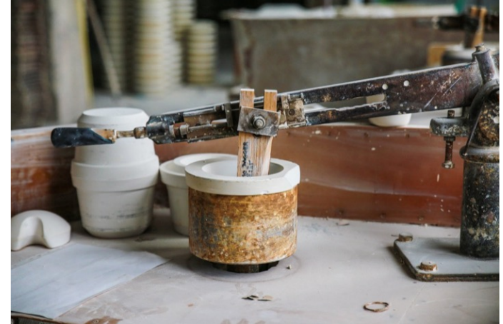
TOČENÍ PORCELÁNU POMOCÍ TLAČNÉ ŠABLONY
