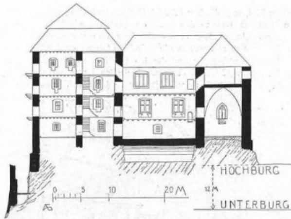
Abb. 203. Pöschau. Längsschnitt durch die Baugruppe der Oberburg.
